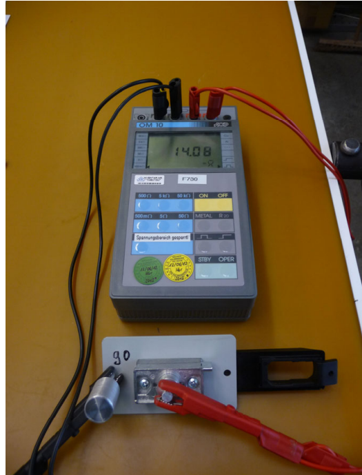
Bild / pic 2: Prüfmuster mit Adapter und Messung mit Micro Ohmmeter, Anzeige 14 mOhm / test sample with adaptor and measurement with Micro Ohmmeter, reading 14 mOhm
