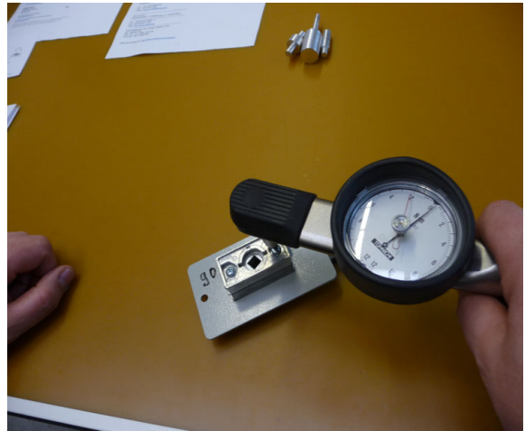
Bild / pic. 8: Anzug der Befestigungsschrauben mit 2 Nm / tightening of the mounting screw with 2 Nm
