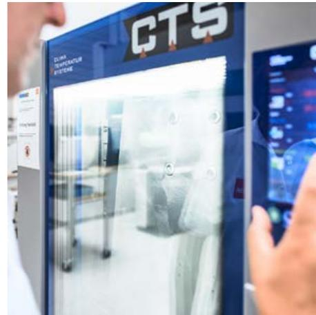
In unserem Klimawechsel-Prüfschrank wird zum Beispiel das Verhalten der Produkte unter extremen Klimabedingungen geprüft. Hierzu werden die Prüflinge für längere Zeiträume hoher Luftfeuchtigkeit, Hitze oder extremer Kälte ausgesetzt. Ob und wie staubdicht das jeweilige Produkt ist, prüfen wir dagegen in der Staubtestkammer. Mit der Kammer erfüllen wir die Testnormen nach DIN EN 60529 für die Prüfung nach IP5X und IP6X. Zu weiteren Anlagen und Prüfständen unserer Produkt-
